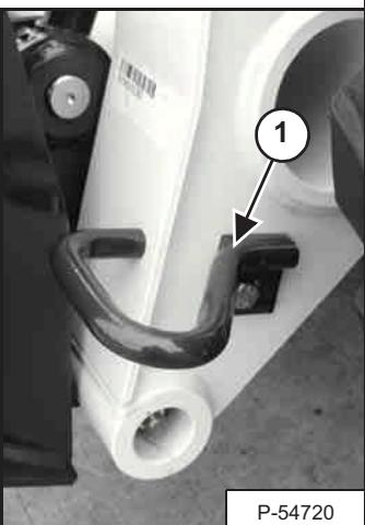
Suunake voolikud läbi voolikujuhiku (pos 1) [Joonis 40] ja ühendage laaduriga kiirliitmikud. (Vt Esmakordne paigaldamine lk 50.)
