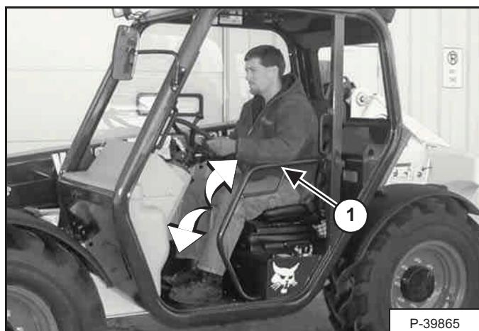
Kinnitage turvavöö, langetage istmepiire (pos 1) [Joonis 67] (kui kuulub varustusse) ja lahutage seisupidur.
