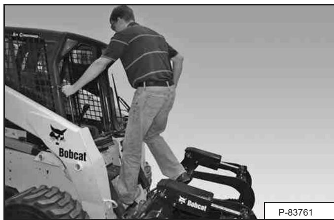
Laadurile minnes ja laadurilt lähkudes kasutage tööseadme astmeid, käepidemeid ja ohutusjalaseid (laaduri tõstelattidel ja raamil) [Joonis 23].
